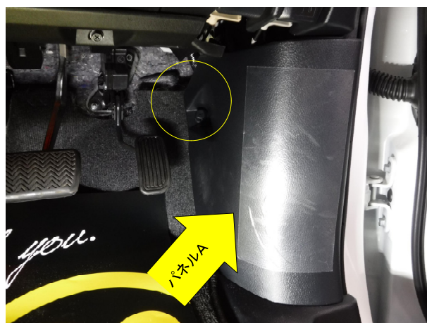
① 樹脂ナットを外し室内運転席側パネルAを手前側に外します。
