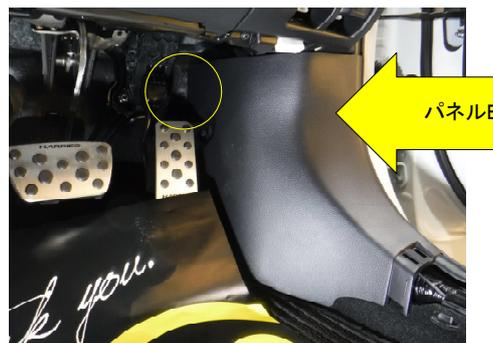
③ 樹脂ナットを外しパネルBを手前側に外します。
