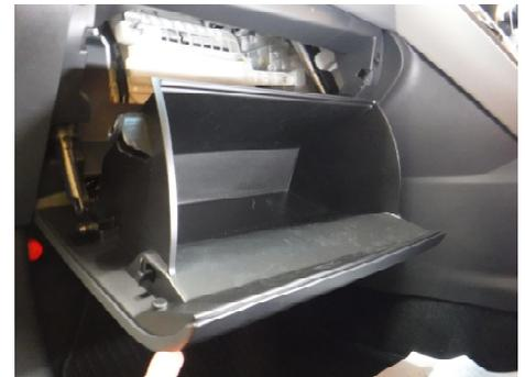
① グローブボックスを開け、ダンパーを外側に外し、●部分(左右)を押しながらグローブボックスを手前側に回転させ、水平位置で手前側に引っ張って外します。
